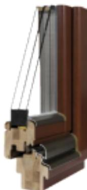
fenêtres ENERGO 78 châssis simple (**vers l'intérieur ouvrants**) Ils sont équipés de **ferrures SIEGENIA Titan**, de **vitrages jusqu'à 42 mm d'épaisseur**, de **joint - d'étanchéité et acoustiques**, et de **larmiers sur le vantail (aluminium ou bois) et le dormant (bois)**. Les fenêtres sont faciles à ouvrir et à fermer. La surface de la fenêtre est protégée par **une peinture**
